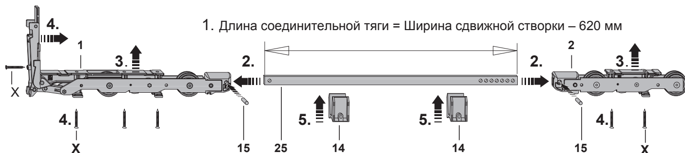
Изоб. 15: Монтаж тележки V (1) и тележки H (2) с соединительной тягой (25)
