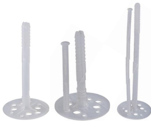
Предназначен для крепления изоляционных материалов: крепят теплоизоляцию к полнотелым материалам, таким как кирпич или бетон. Используется в креплении не тяжелых материалов, как правило, используют порядка 5 дюбелей на 1 м<sup>2</sup> изоляции.
