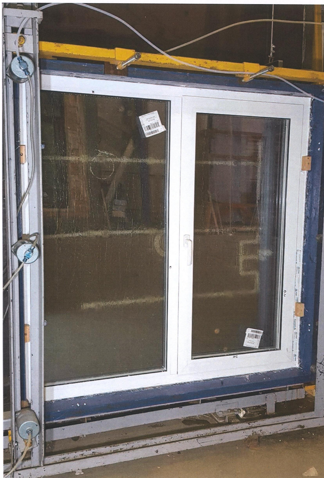
Рис.4 Внешний вид блока оконного при проведении испытания на воздухо- и водопроницаемость
