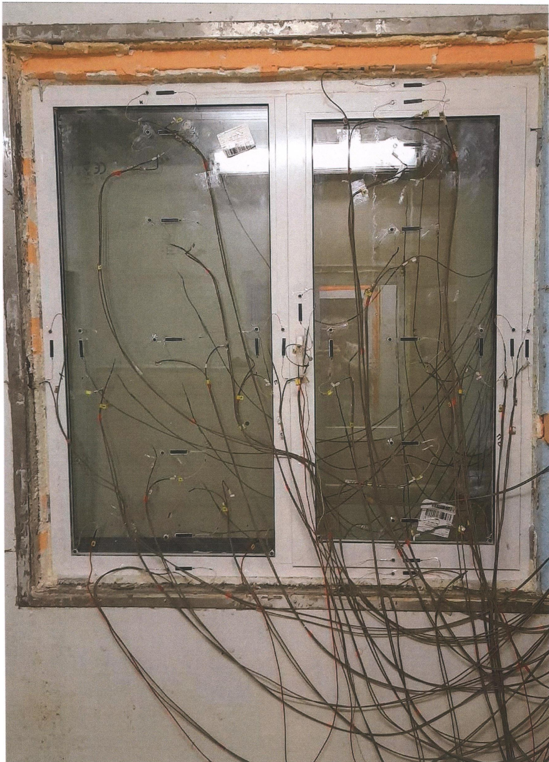
Рис.2. Внешний вид блока оконного, установленного в климатической камере. Вид с внутренней стороны.
