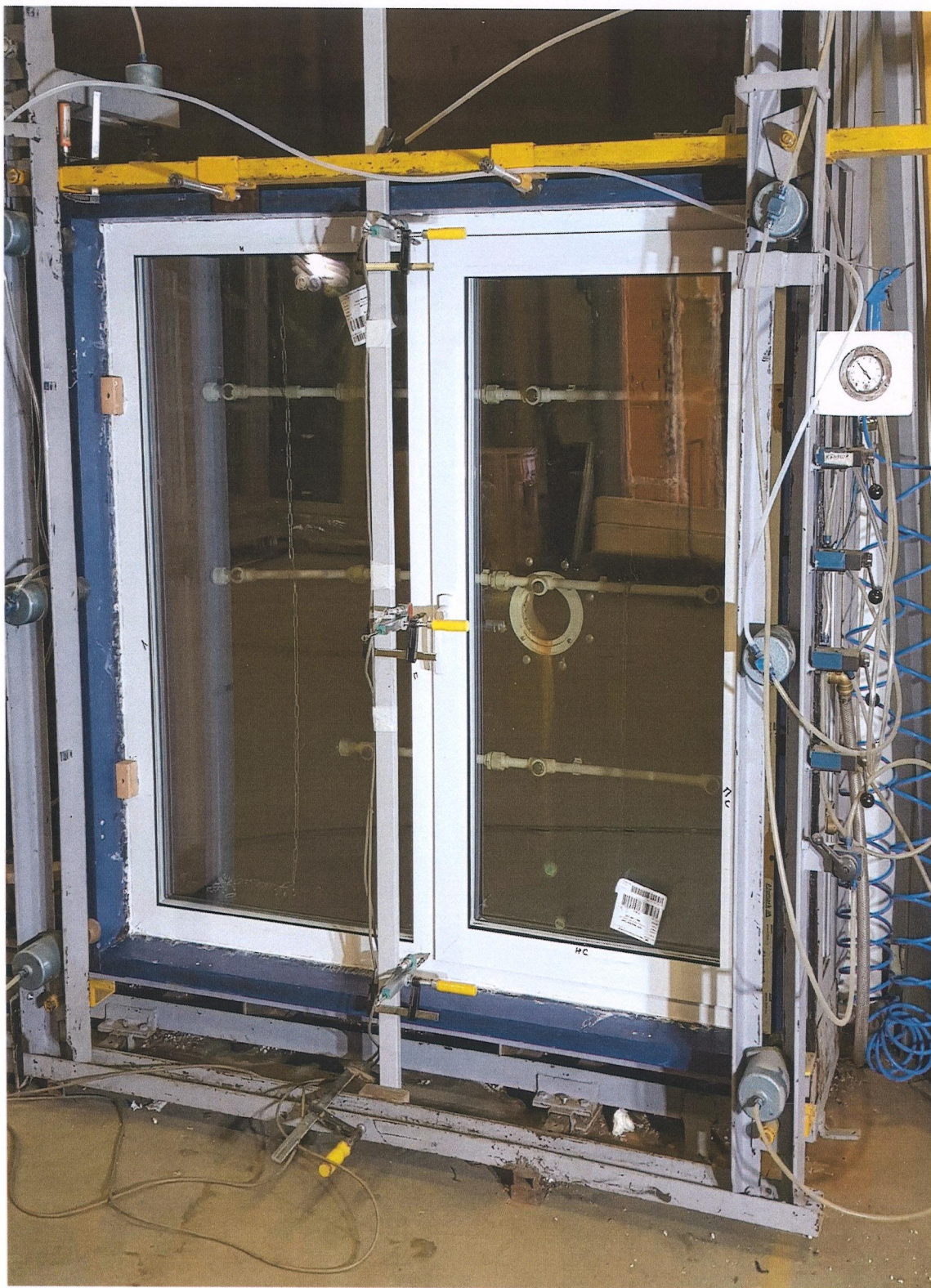
Рис. 5 Расположение датчиков линейных перемещений при проведении испытания на сопротивление ветровой нагрузке
